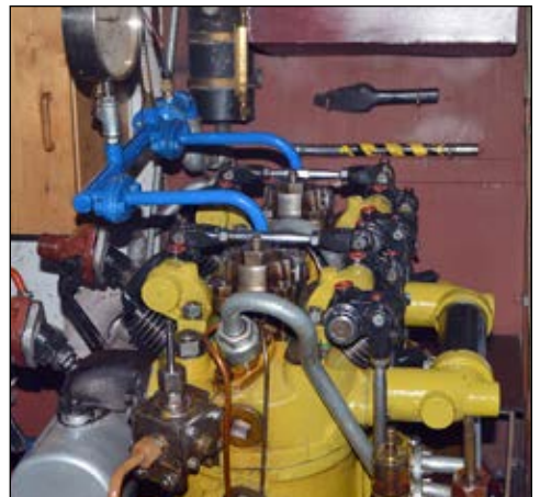
Der 2-Zylinder-Benz-Schiffsmotor aus dem Jahr 1926 verursacht das typische Laufgeräusch
